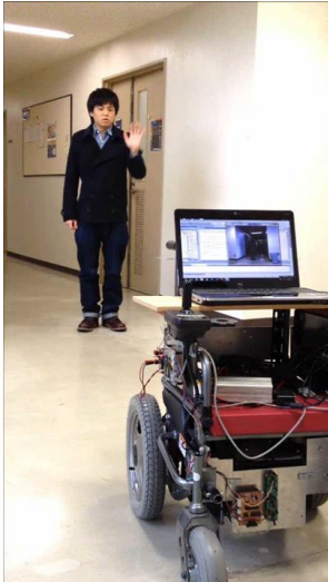
図3 ジェスチャー（右側）と脳波（左側）を利用した車椅子ロボットの制御
