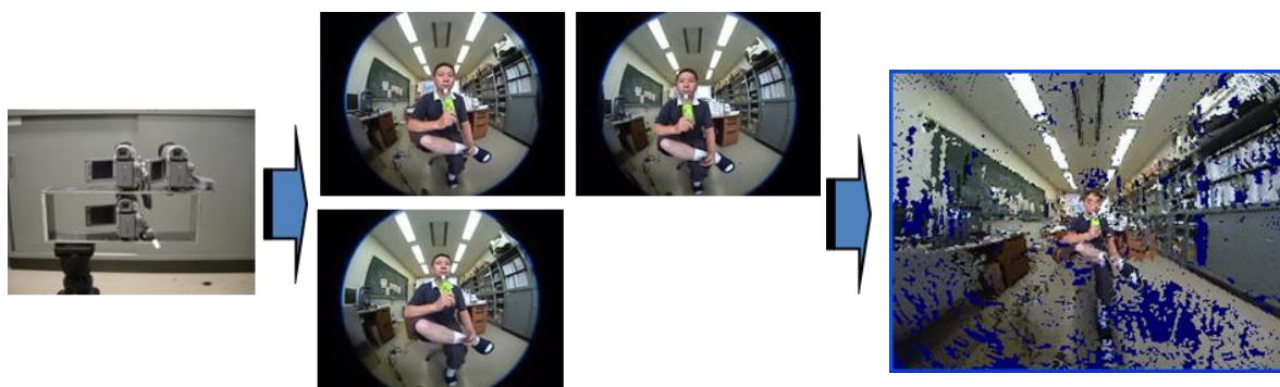
図1 3つの魚眼カメラからなる3眼ステレオ撮像装置(左側)、撮像された3つの魚眼画像(中央)、復元された3次元環境
