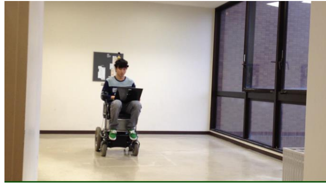
図3 ジェスチャー（右側）と脳波（左側）を利用した車椅子ロボットの制御
